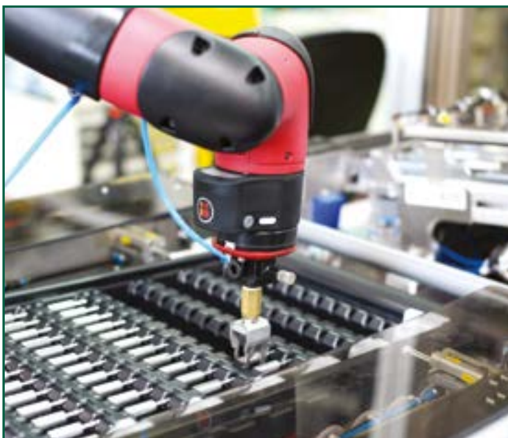
Коботы компании Rethink Robotics оснащены руками с семью степенями свободы. Рабочее устройство на конце таких рук может функционировать в ограниченном пространстве без риска для работающих рядом людей, причём оно способно выполнять операции с максимальной точностью — до 0,1 мм
