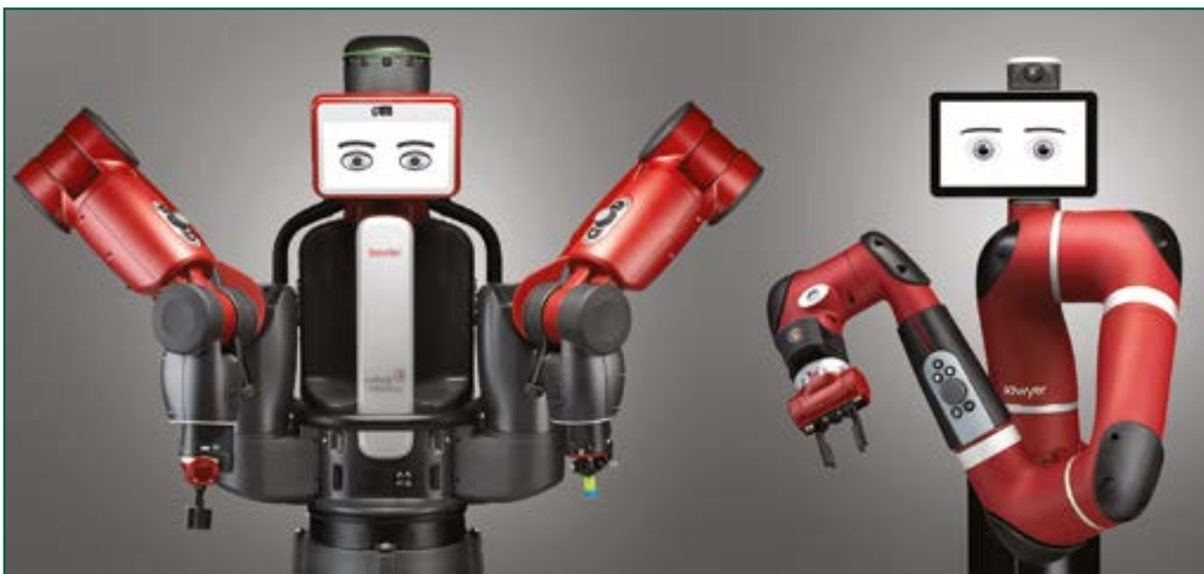
Робот Baxter компании Rethink Robotics (слева сверху) — это сравнительно дешёвый робот, созданный для безопасной работы вместе с людьми на автоматизированных технологических линиях. Его дисплею придали человекообразные черты, выражение которых меняется в зависимости от рода его деятельности: когда робот сосредоточен, экран хмурится; когда случается нечто неожиданное — поднимает брови, и так далее. Справа — его однорукий «собрат» под названием Sawyer
